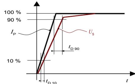
$t_{D10}$  (delay time @ 10 %) and  $t_{D90}$  (delay time @ 90 %)
