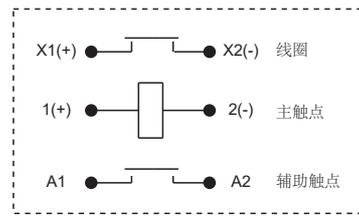
备注: 负载和线圈均有极性; 辅助触点无极性。
